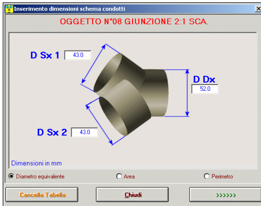
4TBASE: inserimento dati giunzione tra condotti
