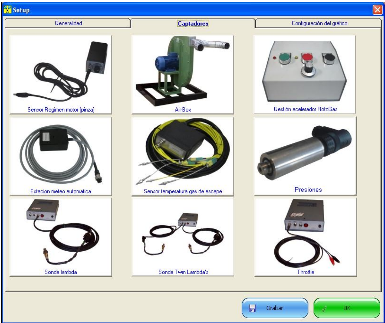
El setup de la prueba - los captadores.
