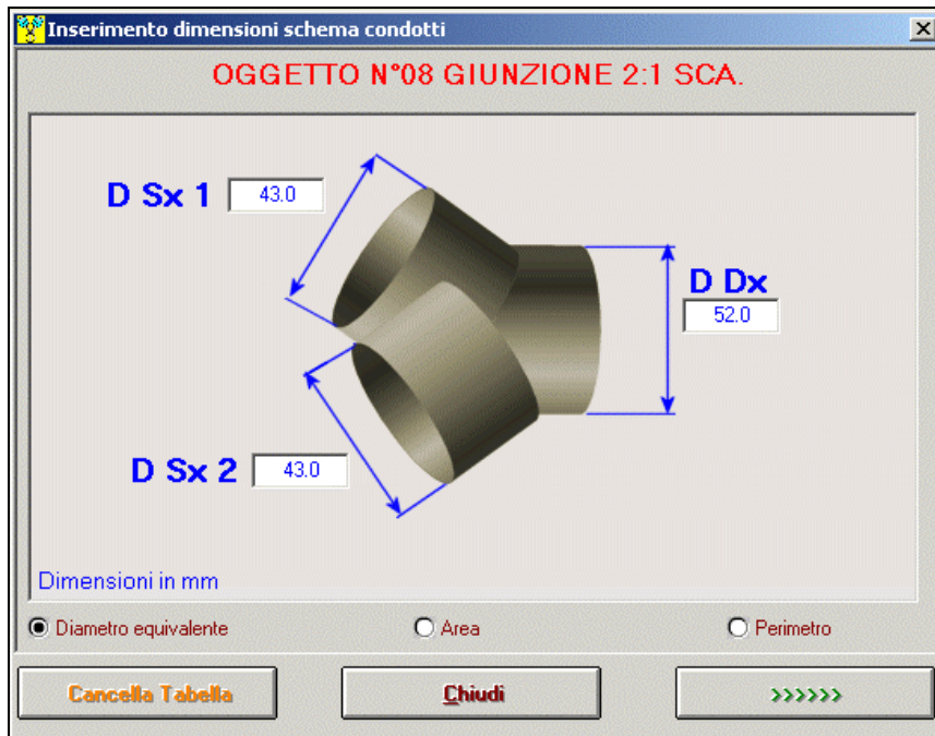
4TBASE: inserimento dati giunzione tra condotti
