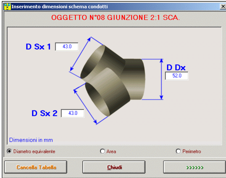
4TBASE: inserimento dati giunzione tra condotti
